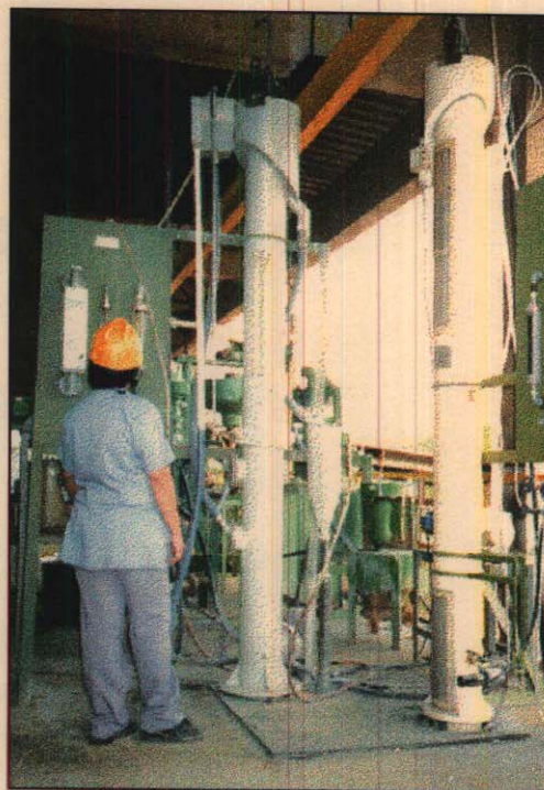
Unidade Móvel de Flotação em Coluna: projeto e desenvolvimento de processos nas unidades industriais (foto: Mineração Morro Agudo, Paracatu, MG)
