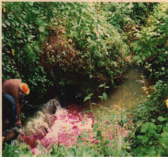
Estudos de Recursos Hídricos: injeção de traçador para medida de vazão em Rio Cedro, Montes Claros -MG
