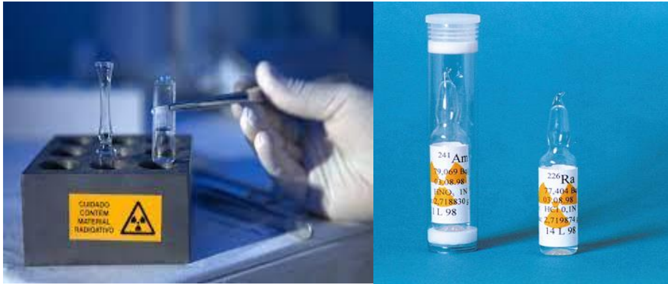
Fontes líquidas em ampolas de vidro Emissores : \alpha , \beta , \gamma Atividade: 1Bq - 50 kBq ^{241}\text{Am} , ^{60}\text{Co} , ^{137}\text{Cs} , ^{210}\text{Pb} , ^{233}\text{U} e outros radionuclídeos
