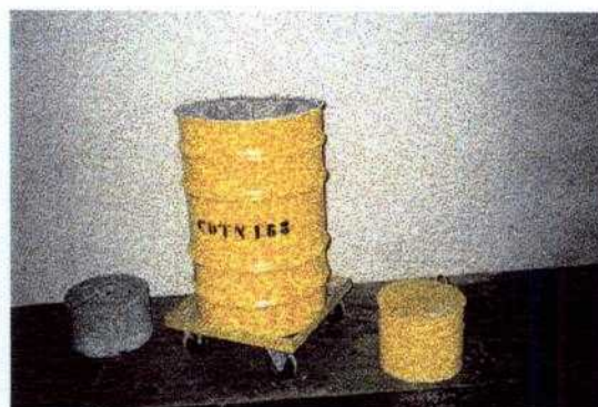
Embalagens de rejeitos: parceria e apoio aos países em desenvolvimento (vista da embalagem desenvolvida, testada e qualificada para acondicionamento de fontes exauridas)
