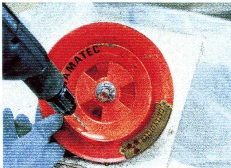
Tratamento de pára-raios radioativos: remoção da fonte de Am-241
