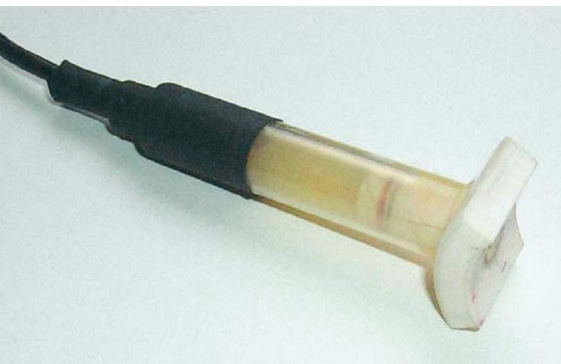
Sonda projetada e construída no CDTN para verificar a integridade do revestimento de combustíveis nucleares em reatores de pesquisa
