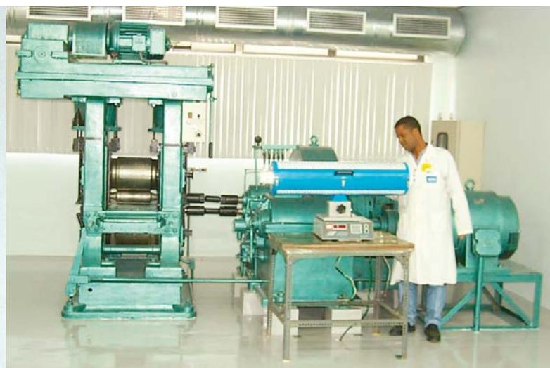
Processo de laminação do combustível nuclear tipo placa
